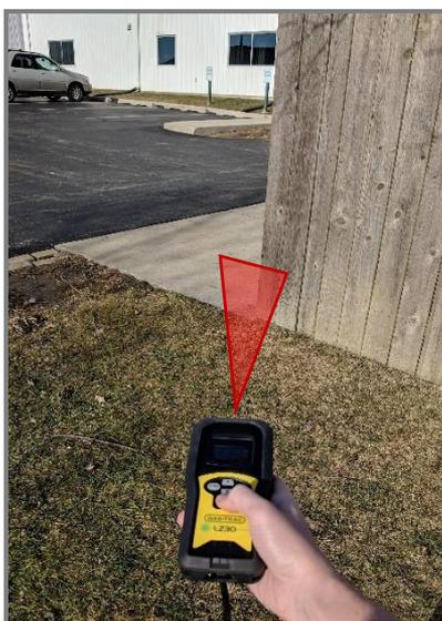
Si l'utilisateur surveille le sol derrière la clôture, cela ne constitue pas un déséquilibre trop important, mais si la cible est la façade du bâtiment à l'arrière-plan, il y aura une très grande différence de signal de retour entre la partie du faisceau qui frappe le bâtiment et la partie qui frappe la clôture.
