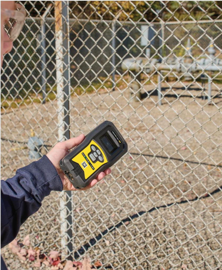
Der LZ-30 von SENSIT Technologies ist ein kompakter methanspezifischer Lecksucher, der schnelle und genaue Messwerte in Entfernungen von bis zu 100 Fuß liefert.
