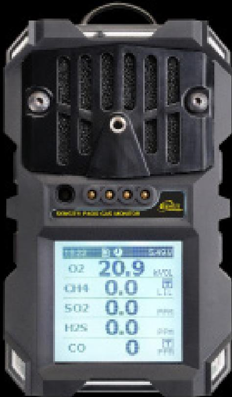
Muestra hasta 5 gases simultáneamente
