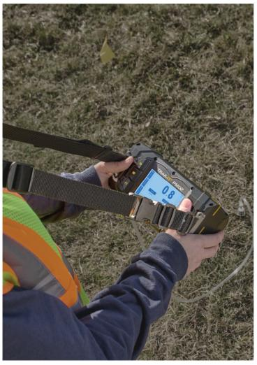
Il **TRAK-IT® PMD2** è uno strumento rilevatore di metano preciso, leggero e compatto, per rilevare, individuare e classificare le perdite di metano. Con la spettroscopia ad asssorbimento laser (TDLAS), **TRAK-IT® PMD2** è selettivo al metano e perfetto per le applicazioni condotte a piedi o con mezzi attrezzati.
